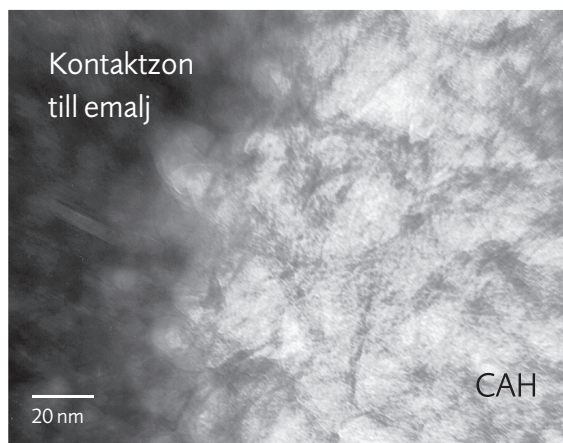
Figur 3. Kemisk integrering av biomaterialet och emalj. Detaljer på atomär nivå visar en total integrering. 300 000 ggr förstoring.
